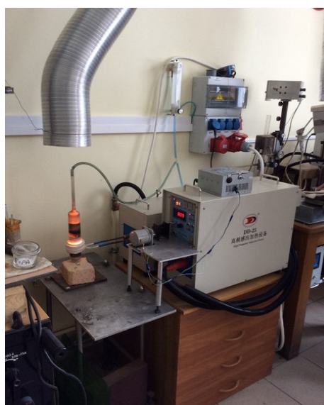
Рис. 2. а) Схема устройства индуктора с химическим реактором. 1- нагреваемое тело (шихта), 2 - источник питания, 3 - кварцевый реактор, 4 - индуктор, 5 - промежуточное нагреваемое тело (тигель); б) общее изображение печи
